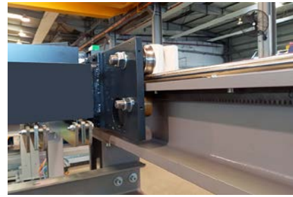
Βαρέως τύπου βάσεις (H) με σύστημα γραναζιού - γραμμαριέρας (ATLANTA Γερμανίας). Ομαλή κίνηση χωρίς δονήσεις.
