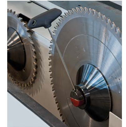
Πρακτικό και αξιόπιστο σύστημα αλλαγής δίσκων easy-change. Εύκολη και σίγουρη αλλαγή δίσκων με τη χρήση ενός μόνο εργαλείου
