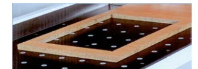
Cut-out σύστημα κοπής παραθύρου
