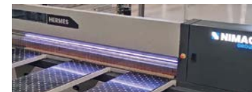
Λευκό φως που αναβοσβήνει Δείχνει την ακριβή θέση τοποθέτησης τεμαχίου - Αποφυγή λαθών
