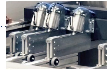
Ενισχυμένος οδηγός μεταφοράς πάνελ με δαγκάνες ανοίγματος 90mm. Κύλιση σε γραμμικούς οδηγούς υψηλής αντοχής. Μεγίστη ακρίβεια με διπλό σύστημα μέτρησης: μαγνητική ταινία - servo.
