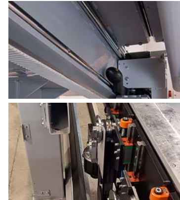
Γραμμικοί οδηγοί υψηλής σταθερότητας σε όλους τους άξονες
