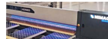
Μπλε φως Κοπή ηλωρίδας που πρέπει να περιστραφεί και να κοπεί ξανά στην τεμαχιστική
